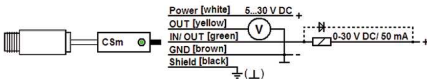
Analoger Anschluss mit Open-Collector-Alarmausgang
