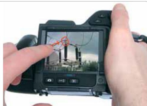
Infrarotbild der gleichen Sicherung mit der MSX-Funktion. Sogar die Schilder sind sichtbar, was auch den späteren Austausch der richtigen Komponente sicherstellt.
