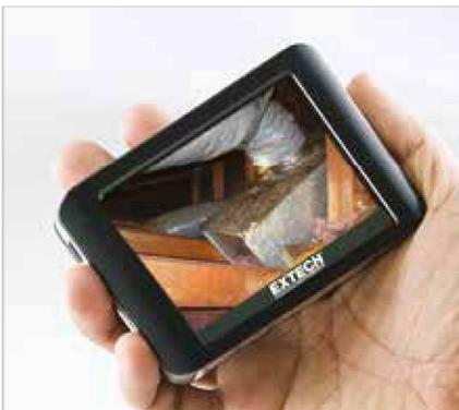
Mit dem abnehmbaren kabellosen LCD-Farbdisplay (3,5") ist die Videoanzeige in bis zu 10 m Entfernung möglich. Kamera mit integrierter LED-Beleuchtung
